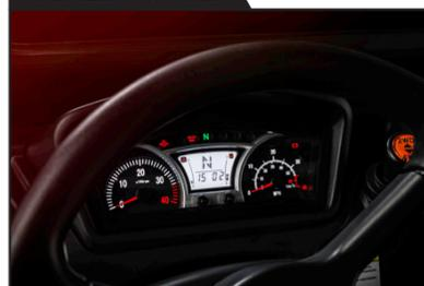
O painel digital, em frente ao condutor, oferece melhor visibilidade a qualquer momento. Todas as funções são verificáveis: velocímetro, conta horas, rpm e gama de marcha.
