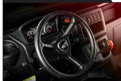
Ajuste simplificado do volante de direção por uma alavanca de pressão, para atender às necessidades do condutor.
