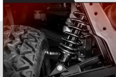
Suspensão com braço duplo dianteiro e traseiro. Amortecedores com mola helicoidal. Os amortecedores absorvem os choques e tornam a condução mais confortável.
